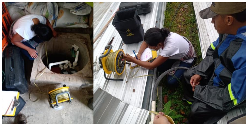
Cálculo de la altura del nivel del agua.
